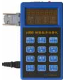
6000H 手持型精密数字测量仪 (6.5 位分辨率, 交直流两用)
