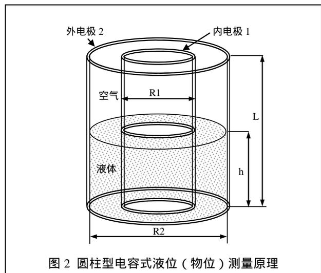
图 2 圆柱型电容式液位（物位）测量原理
