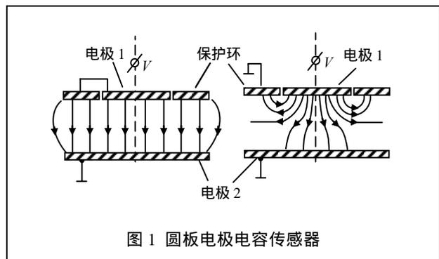
图 1 圆板电极电容传感器
