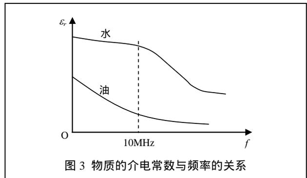
图 3 物质的介电常数与频率的关系
