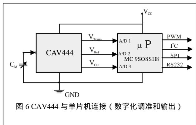
CAV444 测量电容的输出信号可以直接送往后级的 A/D 转换电路或单片机采集电路（见图 6），可以进行补偿、寻址、线性化和数字输出。集成电路上的温度传感器可以监测周边的温度并送往单片机，用来做温度补偿和监控。当然 CAV444 的输出可以直接与变送电路相连输出二线或三线的工业标准的 4-20mA 电流输出。
