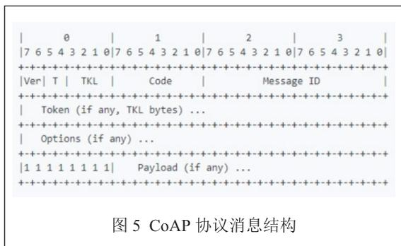
并简化了协议包格式，适用于资源受限型的物联网网络，最小的协议包只有 4B。CoAP 系统中 CoAP Client 与 CoAP server 可以双向通信，双方都可以主动向对方发送请求。CoAP 消息结构如图 5 所示。
