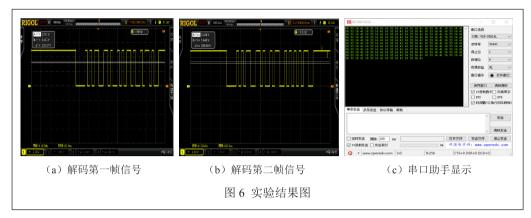
通信效率:两种编码模式互补工作,一旦一方传输信息异常,有效的信息会以另一种模式上传地面系统,保障了井下信号传输的有效性。这种信号传输系统实现了救援井曼彻斯特码通信解码和探测信号的实时采集与编码,有效地保证了通信系统信号传输的高效性和质量,使得救援井探测时间大大地缩短,为救援事故井提供最有效的信息,将事故井所带来的影响降到最低。
