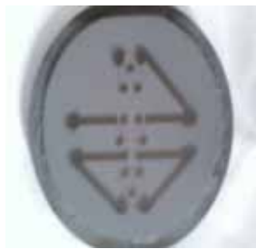
图4 溅射好力敏电阻条的铜片
