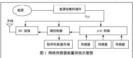
感器的模数转换器、微控制器、射频收发器各部件,保证传感器的电源需求,实现长期有效的供电。能量采收为网络传感器部件供给电能如图 1。
