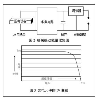
越高,光照越强电流输出越大。使用时为了产生系统需要 的电压需要将多个光电元件进行串行连接。如图 3 是一种 典型光电元件电流、电压与光照、温度关系的 IV 曲线<sup>[2]</sup>。
